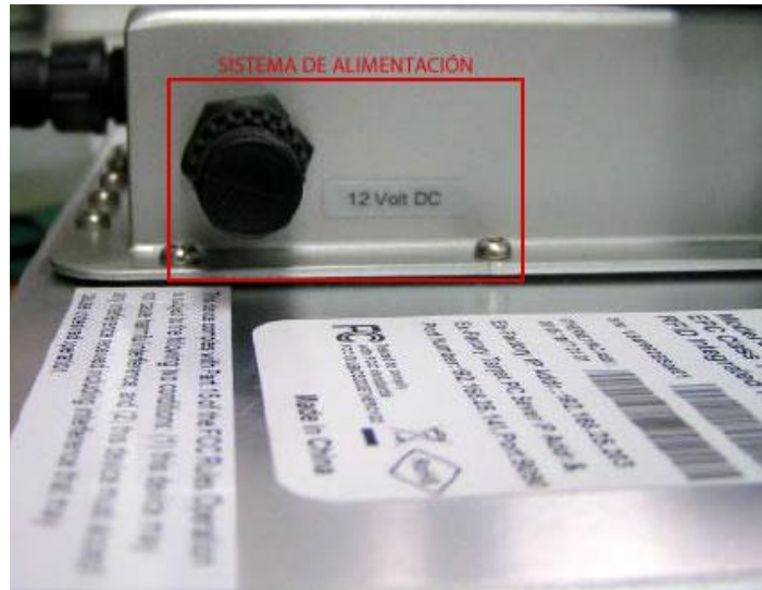
Figura 15. Sistema de alimentación Lector CS203
