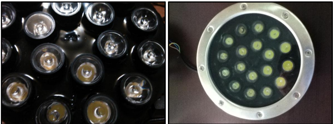
Figura 31: (Izq.) Matriz de LED's de la lámpara a emplear. (Der.) Módulo de luminaria de 12V@ 20W (90 Lumen/W) 31
