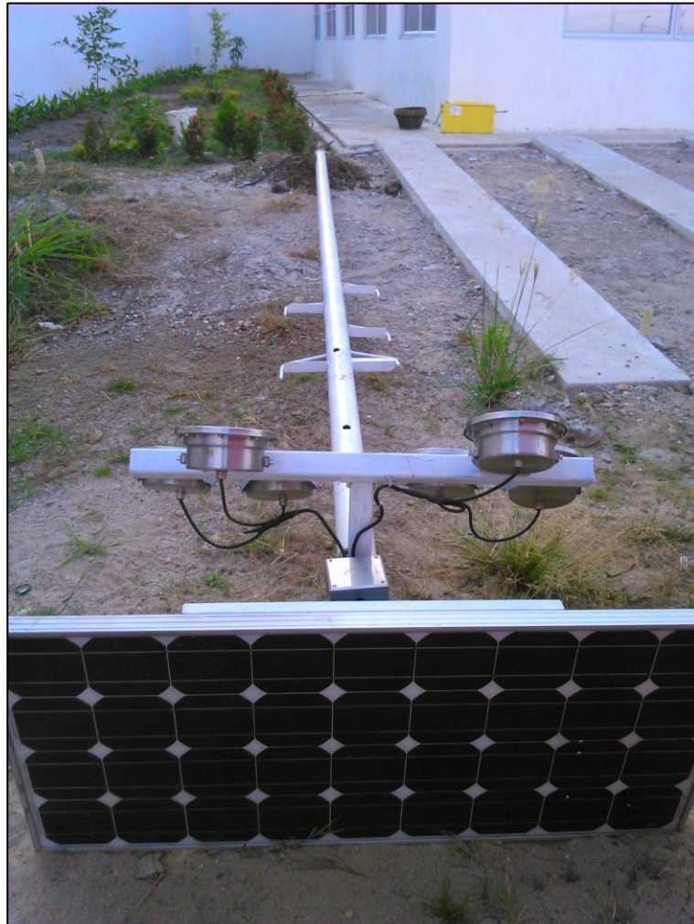
Poste y luminaria, instalado en la sede de Colombia Energy con objeto de prueba (previo al izado).
