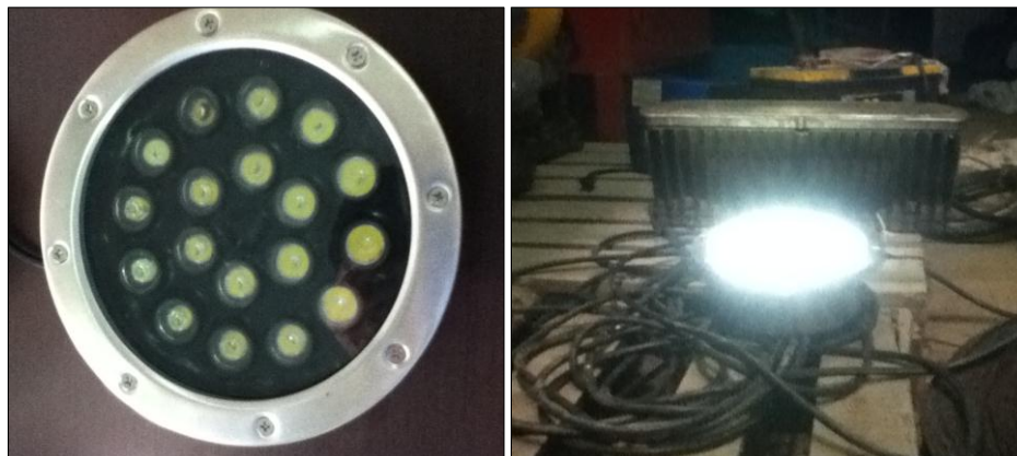
Figura 20: Lámpara LED sometida a prueba de ilumancia y patrón de radiación 20 a.(Izq.) Lámpara LED [Matriz circular de 18 LED's]. Colombia Energy. b. (Der.) Lámpara en prueba de iluminancia.
