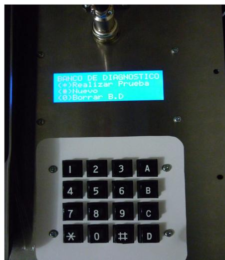
**Figura 36.** Sistema de diagnóstico portable ensamblado
