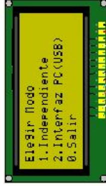
La opción **1, Independiente**, trabaja con el maletín sin hacer uso de un computador portátil; el sistema está diseñado para comodidad del usuario.
