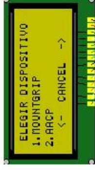
Por defecto el S.D.P tiene la posibilidad de realizar la prueba tanto con el dispositivo MOUNTGRIP como con el AACP, sin embargo es expansible hasta 30 dispositivos. Al elegir presionar la tecla **1** o **2**, en pantalla (Figura 8) se presentara una precaución.
