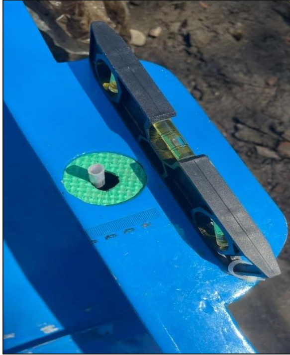
Figura 6. NIVELACIÓN PREVIA PARA EL DISPOSITIVO
