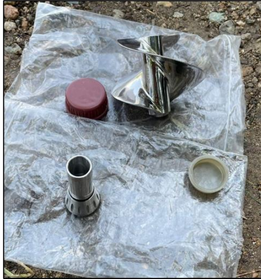
Figura 10. SEPARACION DE VENTILADOR Y EJE DE ROTACIÓN.
