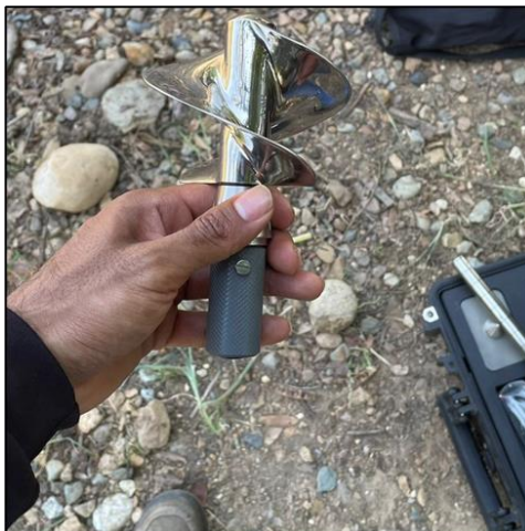
Figura 12. PRUEBA DE GIRO DEL VENTILADOR.
