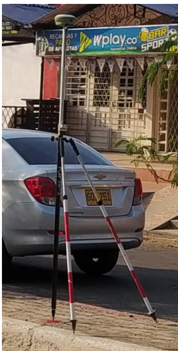
ANEXO 6. Captura de puntos de estudio con metodología RTK: Fuente propia.
