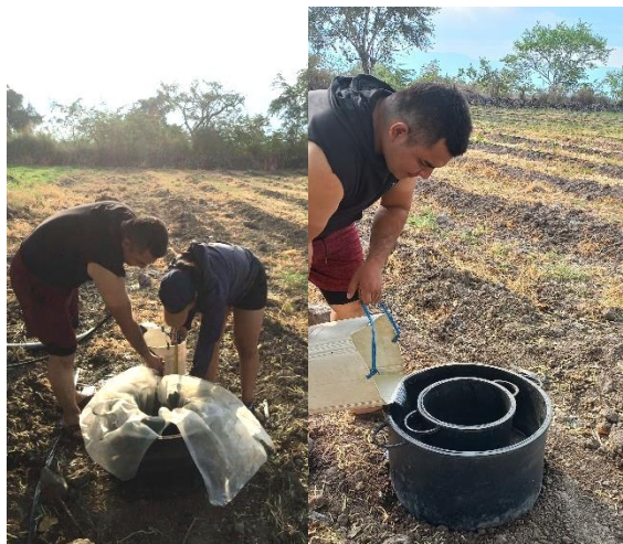
FIGURA 8. Prueba de infiltración, método de anillos.
