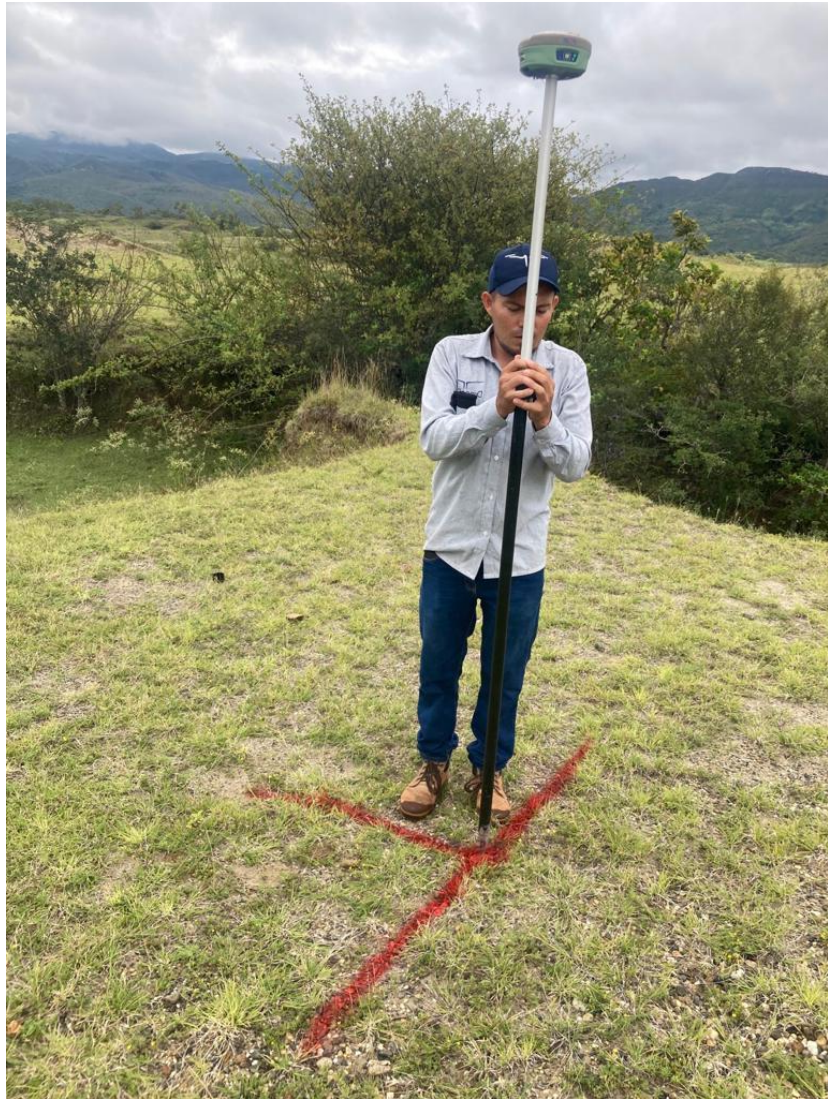
ANEXOS 3. Replanteo de los puntos en campo.
