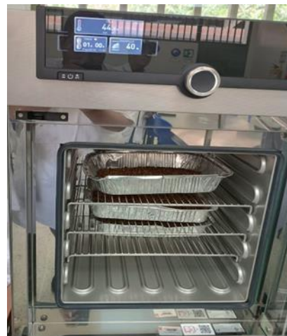
b. Muestra de cacao en estufa de convección forzada.
