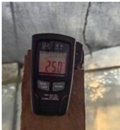
Figura 4. a. Termo-higrómetro digital Datalogger.
