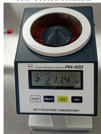
d. Medición de humedad final en equipo PM-450.
