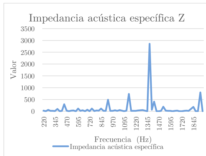
Figura 4-10: Coeficiente de Impedancia Acústica Z (Patrón). Fuente: Elaboración propia.
