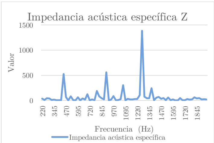
Figura 4-13: Coeficiente de Impedancia Acústica Z (Reemplazo 10 %). Fuente: Elaboración propia.
