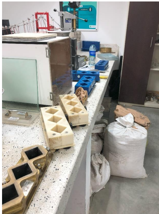
Figura B-7: Formaletas para las muestras cúbicas, proceso de fundición. Fuente: Elaboración propia.
