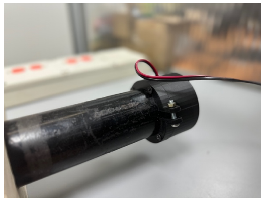
Figura 3-10: Altavoz y generador de señales acústicas. Fuente: Elaboración propia.
