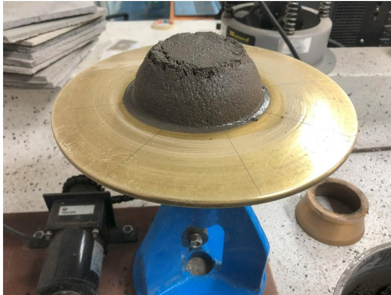
Figura B-6: Toma de medida ensayo de fluidez. Fuente: Elaboración propia.
