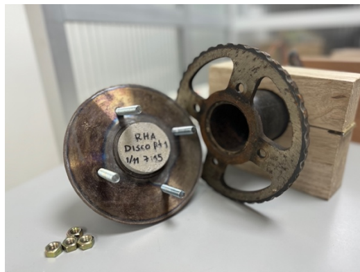
Figura 3-7: Soporte de muestra o portamuestras de prueba. Fuente: Elaboración propia.
