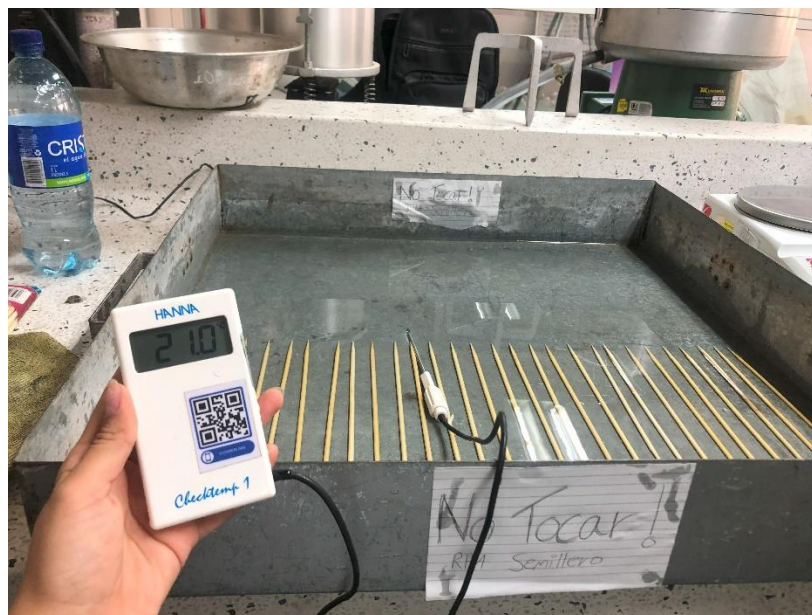
Figura B-11: Control de temperatura del agua, ensayo de sortividad. Fuente: Elaboración propia.
