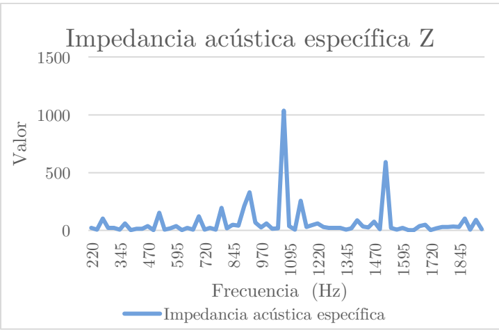
Figura 4-19: Coeficiente de Impedancia Acústica Z (Reemplazo 20 %). Fuente: Elaboración propia.
