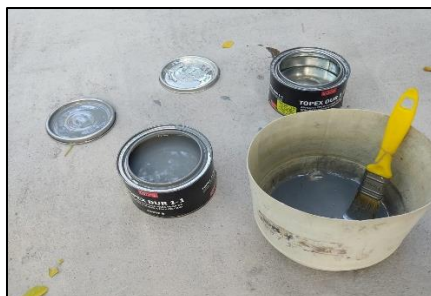
Figura 3-7: Topex Dur 1-1 para aplicación de las tablillas de guadua.
