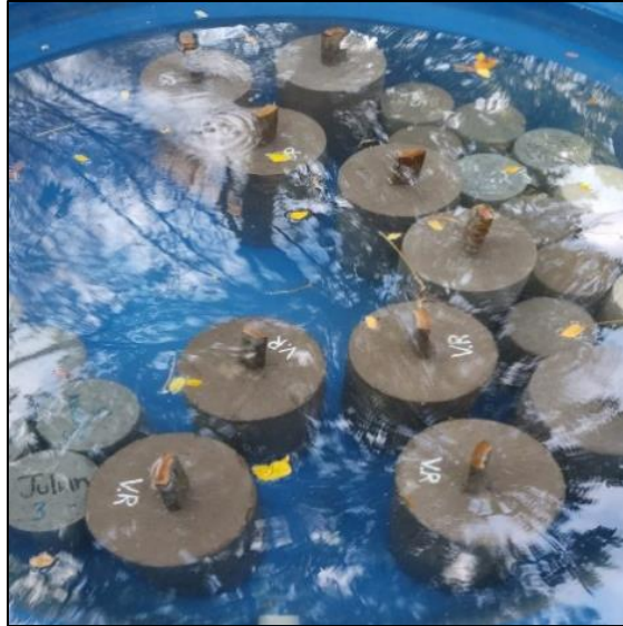
Figura 3-8: Tanque utilizado para el proceso de curado.
