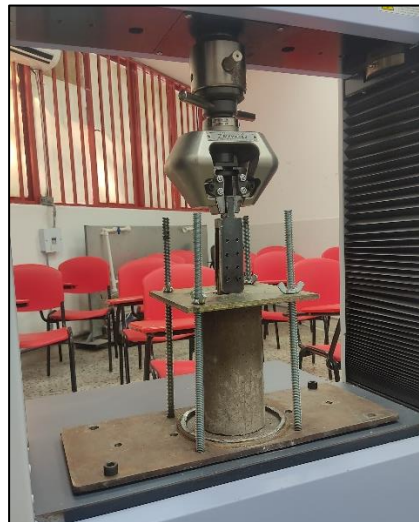
Figura 3-10: Pieza metálica ensamblada en la maquina universal preparada para realizar el ensayo a tracción.
