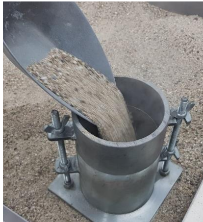
Figura 3-5: Llenado del molde para hallar la masa suelta.
