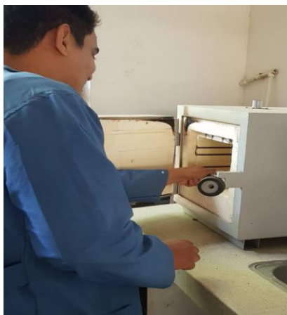
Figura 3-2: Calcinación en mufla de la CA.
