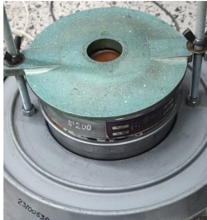
Figura 3-9: Tamizado de la CCA ya molida.
