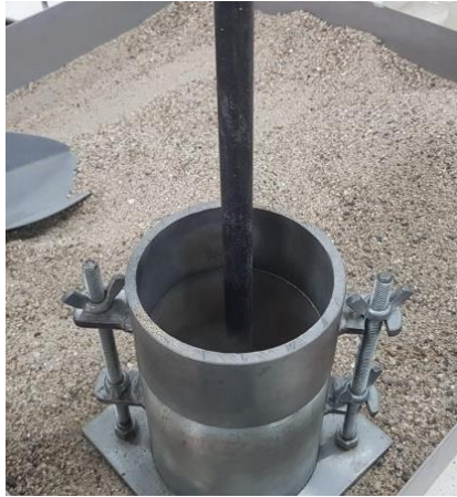
Figura 3-6: Llenado y compactación del molde para hallar la masa compacta.
