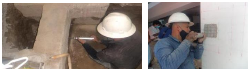
Figura 3-4: Registro fotográfico de ensayo de esclerómetro a los elementos estructurales. Fuente: Servi.Lab Ingeniería.
