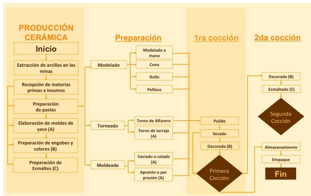
Figura 36. Proceso elaboración productos Cerámicos
