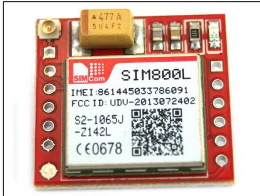
**Figura 15.** Mini Modulo SIM800L GPRS GSM. Tomado de belajarduino.com
