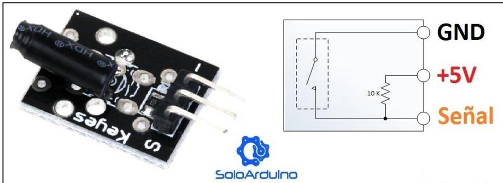
**Figura 12.** Sensor de vibración KY-002 Tomado de soloarduino.blogspot.com
