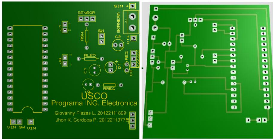
**Figura 32.** Aproximacion real del diseño de la PCB
