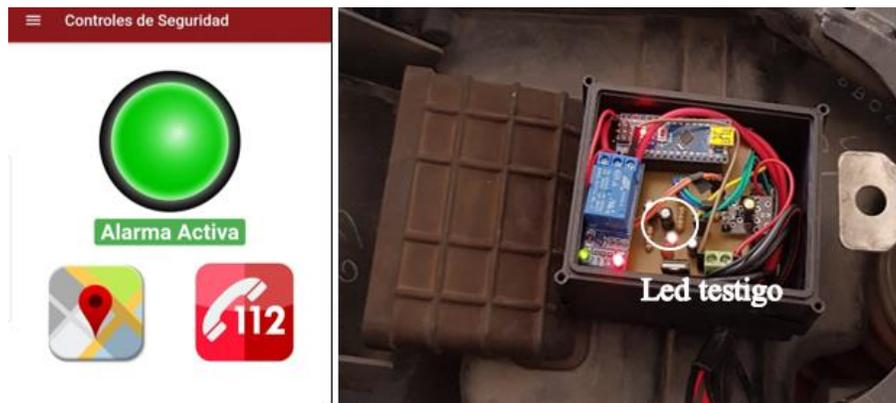
**Figura 78.** Prueba sensor de vibración, alarma activada.
