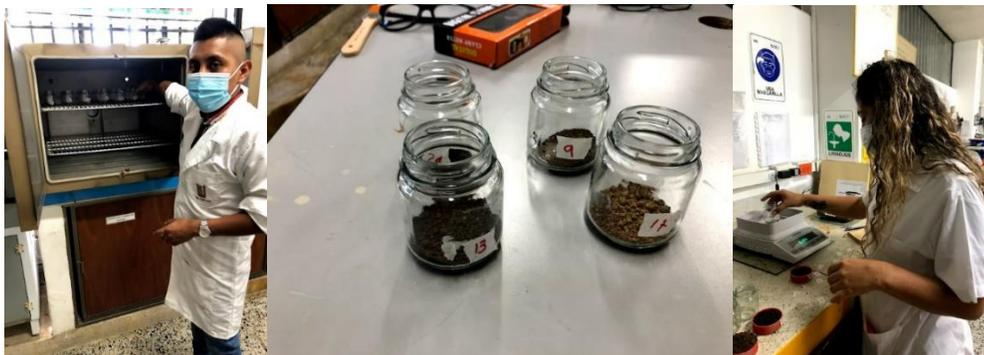
**FIGURA 4.** Procedimiento para determinar la pérdida de humedad de las muestras secadas al horno.
