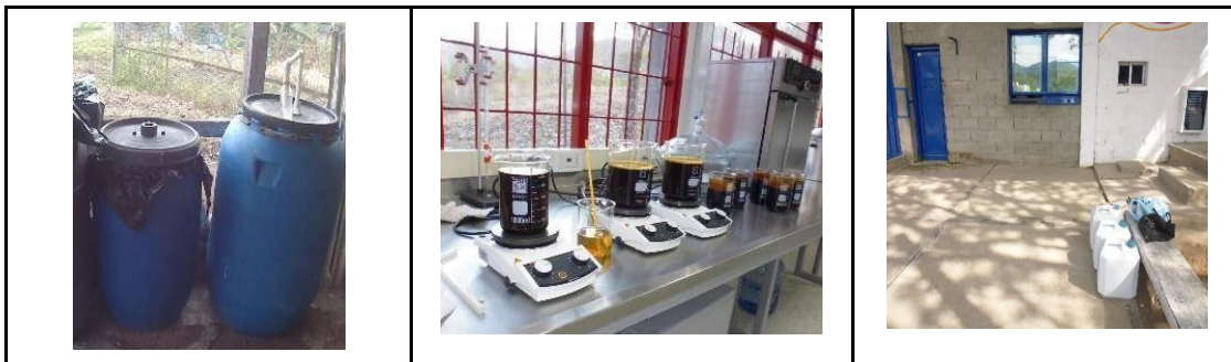
FIGURA 5. De izquierda a derecha: caneca de 55 galones con adaptación en la tapa, pasteurización de melaza a 80°C e ingreso de las cepas para la activación de microorganismos y activador al centro penitenciario
