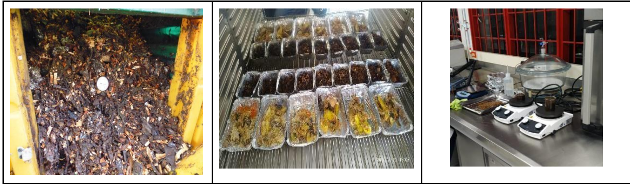
FIGURA 7. De izquierda a derecha, monitoreo de temperatura en la compostera, muestras en estufa para determinación de humedad y homogeneización de muestras en agitador magnético para medir PH y CE.
