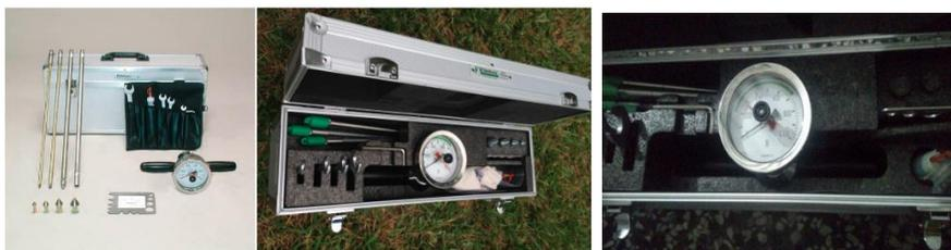
**Ilustración 7.** *Dispositivo Manual – Penetrómetro*
