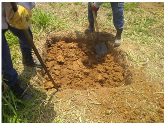
**Ilustración 9.** Calicata realizada en campo con dimensiones de 1m x 1m x 1m
