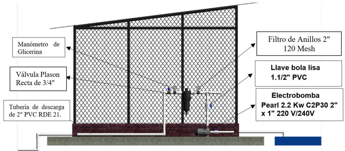
Ilustración 14. Centro de control o cabezal del sistema de riego
