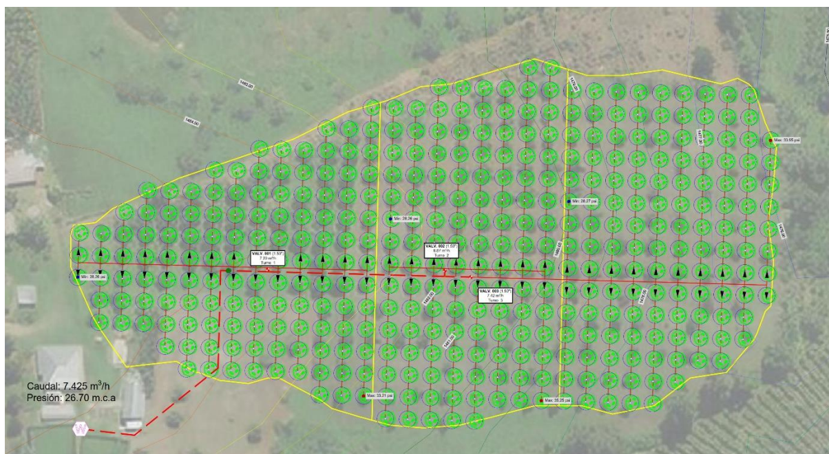
Ilustración 8 Diseño sistema de riego por microaspersión autores Juan Felipe Ramírez y Andrés Vanegas
