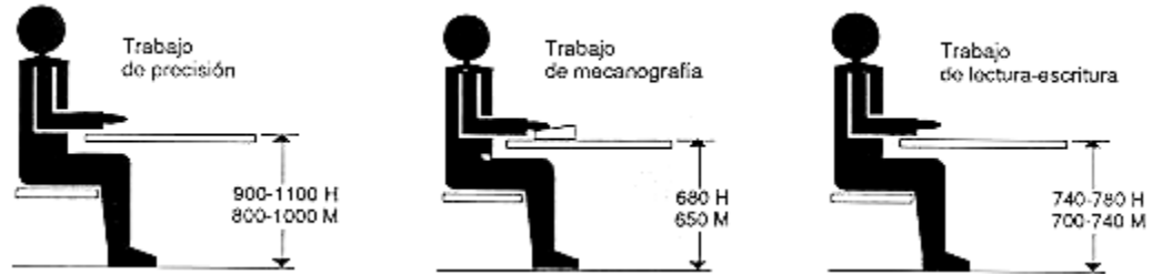
Figura 6. Altura del plano de trabajo para puestos de trabajo sentado (cotas en mm)
