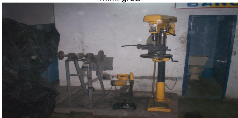
Tronchadora de corte, esmeril y taladro radial
