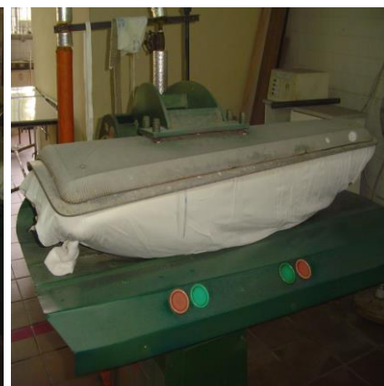
Planchas semi-industriales e industriales en regular estado y con fugas térmicas.
