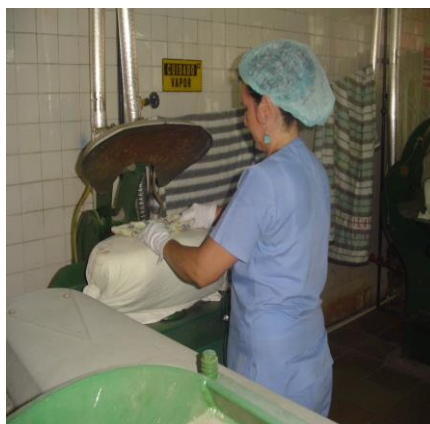
Planchas semi-industriales e industriales en regular estado y con fugas térmicas.
