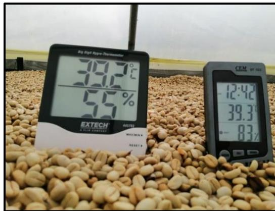
Figura 7. Calibración de termohigrometros
