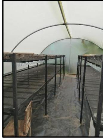
*Figura 2. Parte interna secador solar tipo marquesina (bandejas)*
