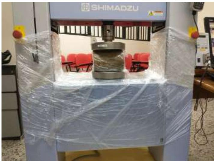
La máquina empleada para el ensayo a la compresión perpendicular a la fibra fue AGS -100 KNX SHIMADZU (ver figura 24), la cual funciona con el software de procesamiento de datos TRAPEZIUM X y cuenta con un panel de operación principal incorporado con pantalla digital de una resolución de 0.001 mm. Esta máquina
