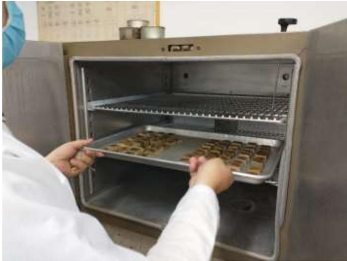
El contenido de humedad de las probetas ensayadas, se determinó de acuerdo a lo estipulado en la NTC 5525, para lo cual, se hace uso de la siguiente ecuación:
