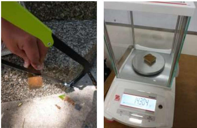
Posteriormente, las muestras fueron pesadas en una balanza de precisión electrónica OHAUS, con una exactitud de 0.01 gr, introducidas en una bolsa ziploc, para evitar la pérdida de humedad hasta finalizar la jornada, y luego se retiraban de la bolsa para ingresar al horno eléctrico HUMBOLDT MFG. CO. a una temperatura de 103 °C por 24 horas. Una vez finalizado este periodo, se midió su masa cada 2 horas hasta que la diferencia entre las masas no superaba 0.01 gramos (ver figura 26).
