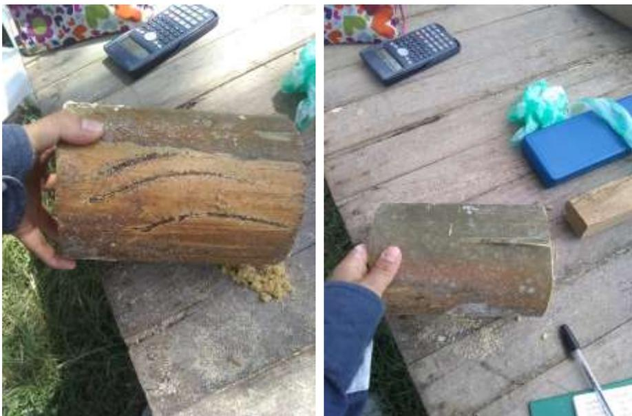
Con el proceso de perforación, se realizó nuevamente selección de los especímenes que serían ensayados, para lo cual se eliminaron 139 probetas que sufrieron daños por pérdida de humedad y fisuras a la hora de la perforación. Finalmente, durante el transcurso de los 5 meses para la obtención de los permisos de movilidad y salvoconducto de transporte de la guadua, se eliminaron 150 probetas, dañadas por la humedad. El total de las probetas que se ensayaron es igual a 136.
