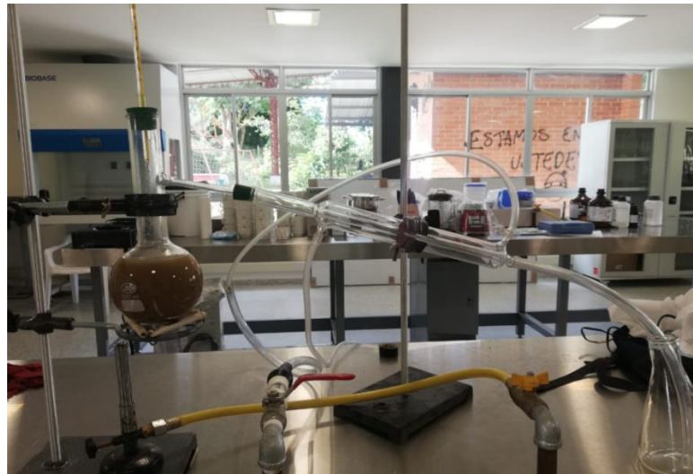
Figure 4. Montaje de destilación simple.
