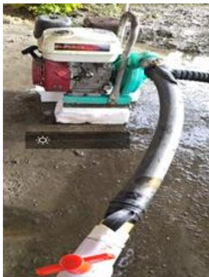
*Figura 31. Motobomba Utilizada en la recirculación del flujo de agua.*
