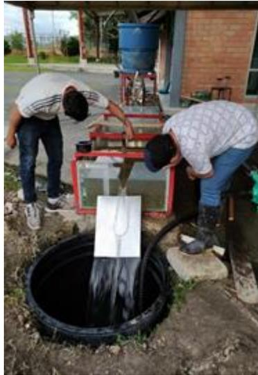
*Figura 32. Banco hidráulico construido. Fuente: Autores.*
