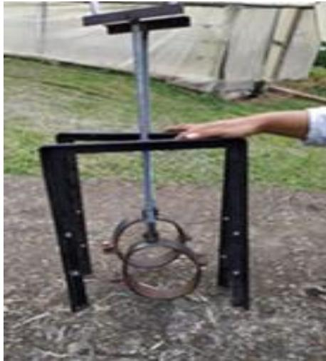
Figura 28. Collarines para sujetar la guadua. Fuente: Autores.
