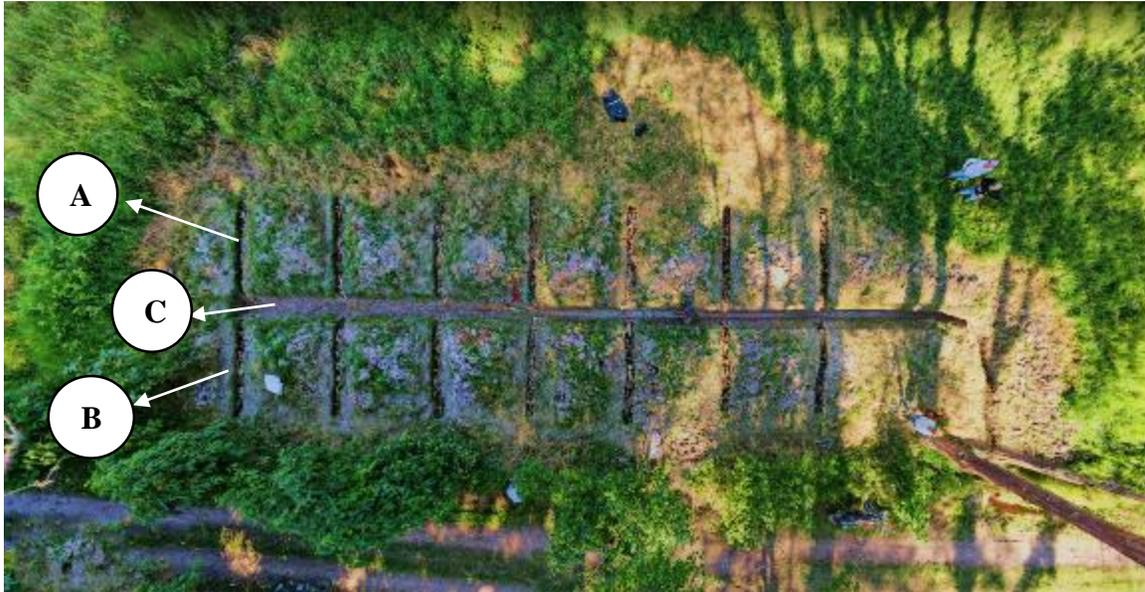
**Figura 35.** Instalación del sistema de drenaje en tubería de guadua.
