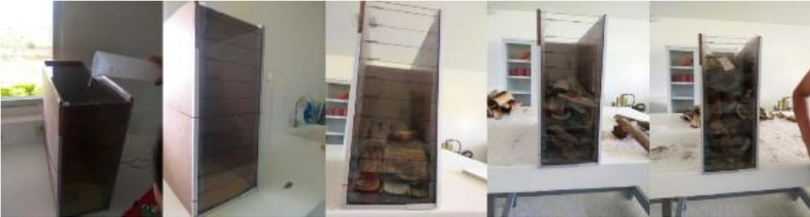
**Figura 16.** Proceso de aforo del recipiente y toma de volúmenes de filtro.
