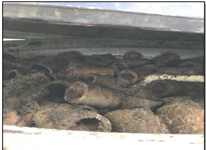
Figura 17. Reactor Metanogénico Inoculado.
