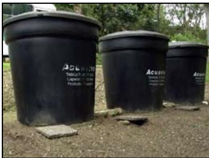
Figura 9. Reactores Hidrolíticos - Acidogénicos ubicados en serie.
