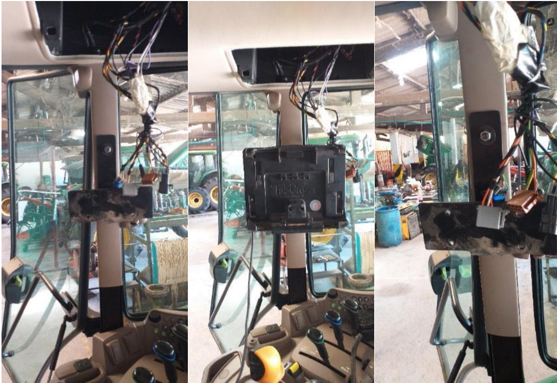
Instalación de soporte para Tablet iGrade en tractor 6110M
