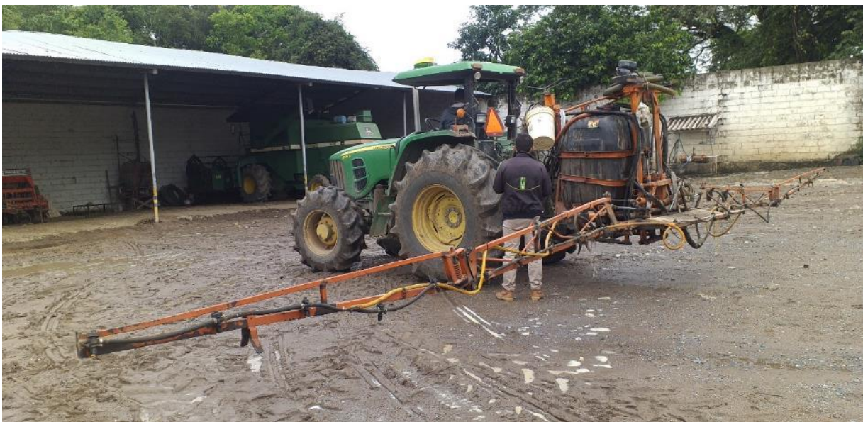
Calibración de fumigadora con control secciones en tractor 6125D
