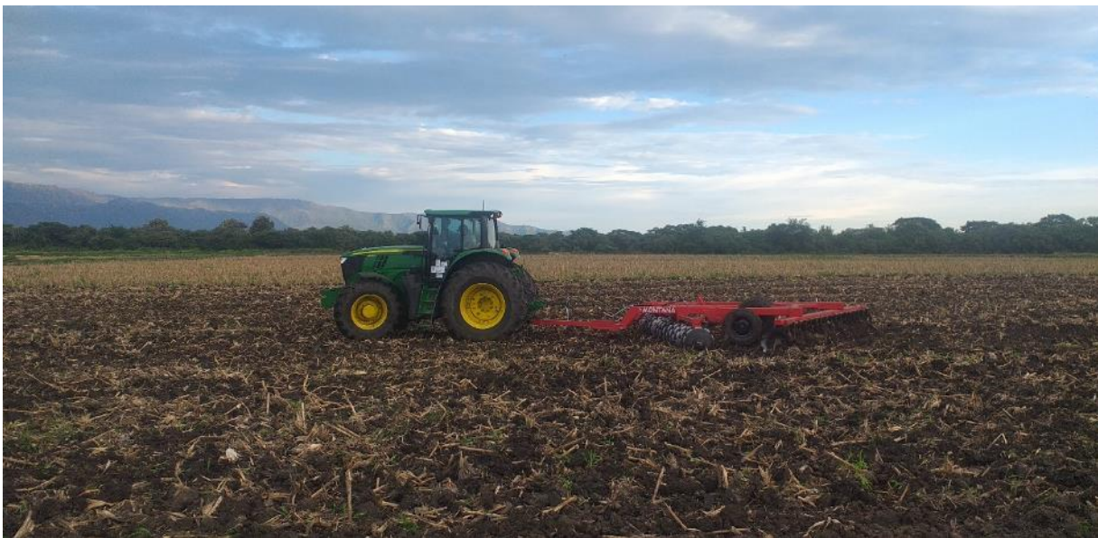
Prueba de rendimiento con rastra montana de 32 discos en tractor 6175M
