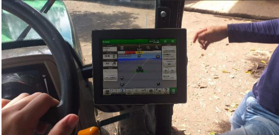
Realización de curvas de nivel con StarFire 6000 como estación con señal RTK, en un tractor 6603 con taipa en el municipio de Puerto Boyacá
