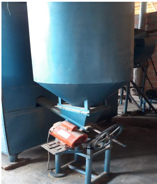
Figura 21. Tolva y motor par alimentación de cisco
