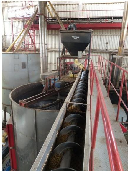
*Figura 15.* Tornillo sin fin transportador de café a verticales 3-4-5-6.
