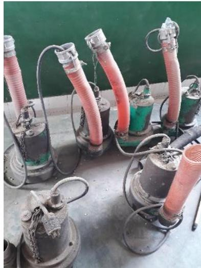
*Figura 22.* Electrobombas para transporte de café a los sistemas de secado.
