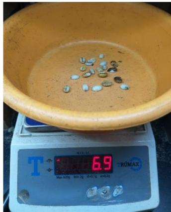
*Figura 18.* Peso de granos pelados después de ser transportada la muestra por el equipo Centriflux.
