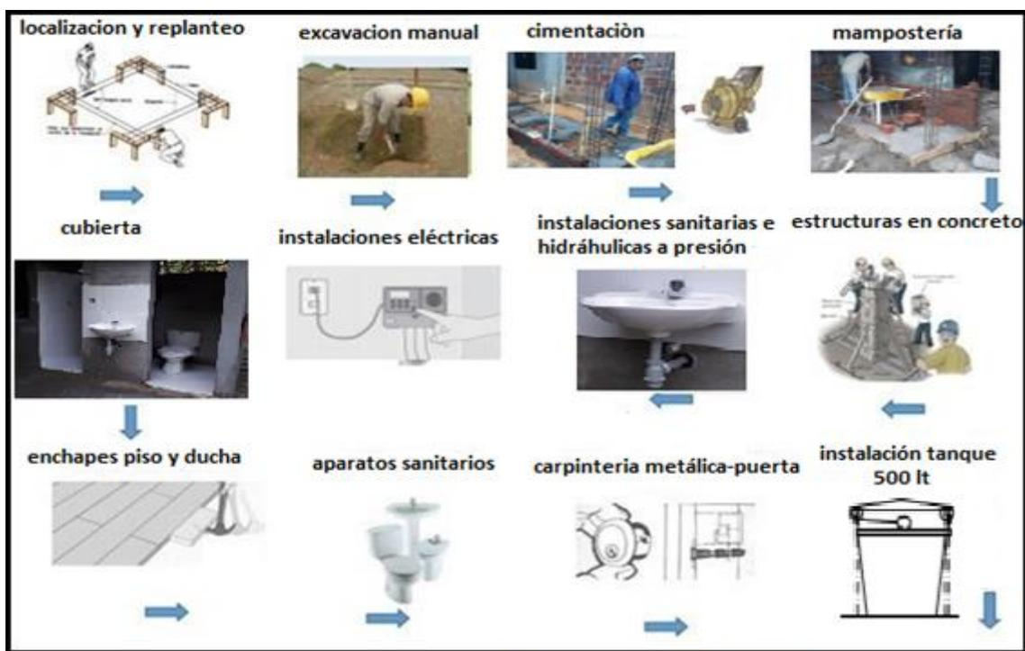
Figura2. Procedimiento constructivo del sistema séptico.
