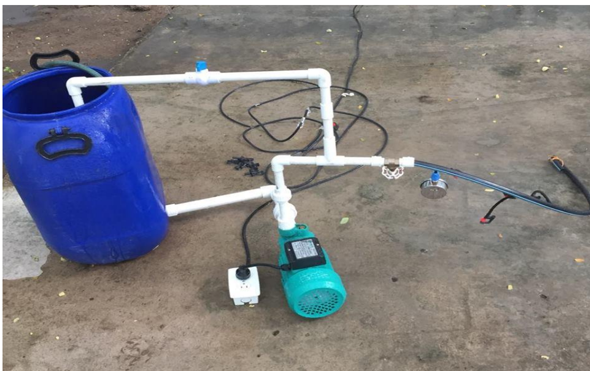
Fotografía 8. Prueba para la determinación de los coeficientes de uniformidad y de variación.
