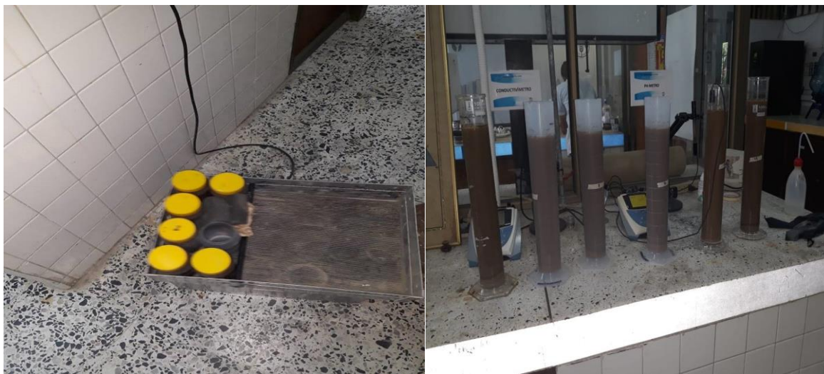
Fotografía 8. Prueba para la determinación de los coeficientes de uniformidad y de variación.
