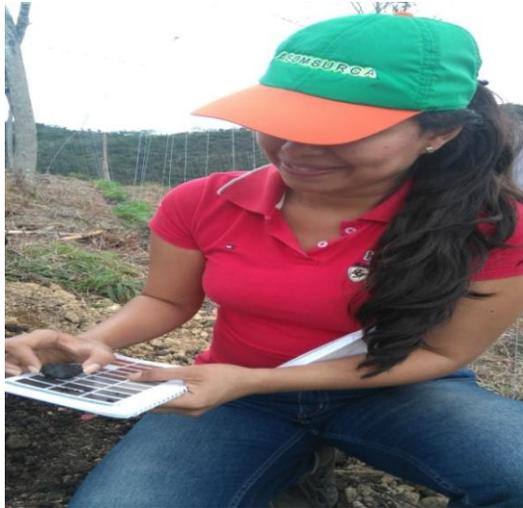
**Imagen N° 13.** Determinación del color del suelo en seco y húmedo, con ayuda de la Tabla de colores propuesta en el Manual Rasta.
