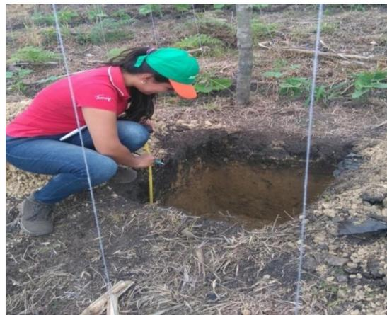
**Imagen N° 12.** Medición de horizontes de calicatas.
