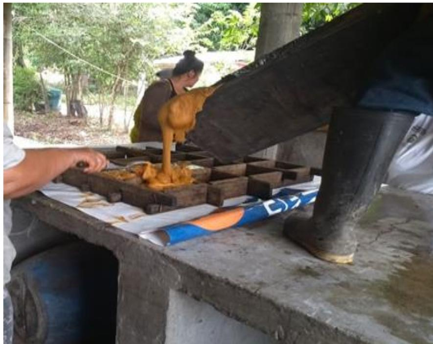
Figura 11. Clarificación y evaporación del jugo de la caña
