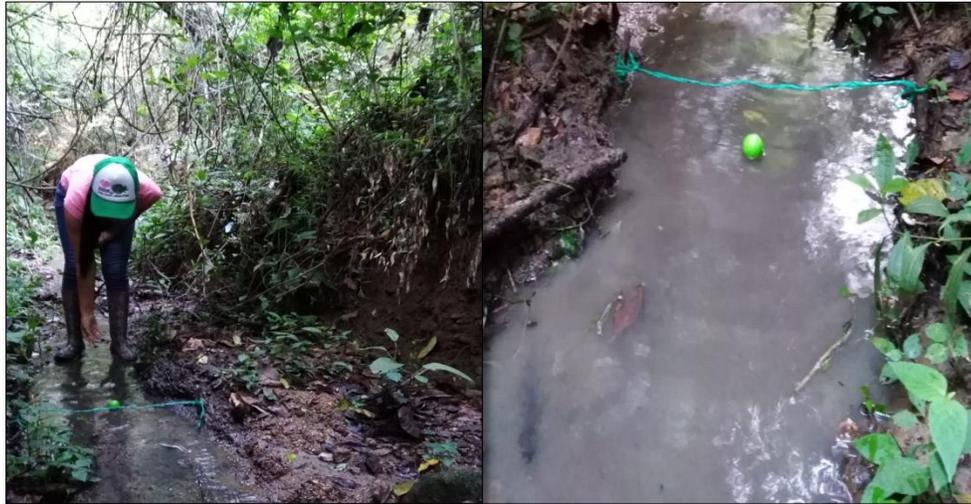
Figura 6. Aforo con flotador.
