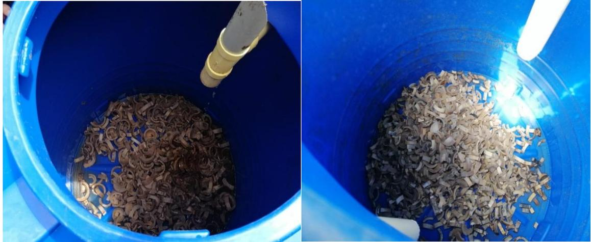
*Figura 34. Filtro anaerobio de guadua 1 y 2 con semicírculos y cuartos de círculo de guadua.*
