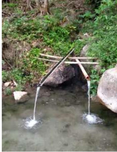
Figura 5. Tubos utilizados para la medición del caudal.
