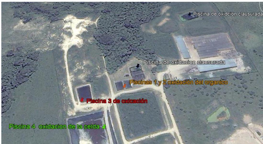
Figura 11 Distribución de las piscinas de oxidación
