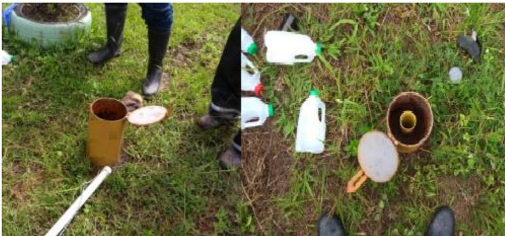
Figura 9. Extractor de aguas para los Piezómetros.
