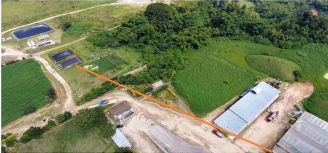
Figura 5 Línea de conducción del lixiviado desde la zona de compostaje a las piscinas de oxidación.
