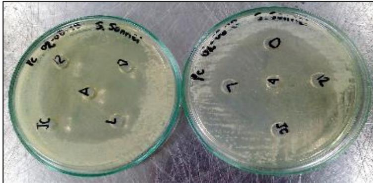
**Figura 20.** Ensayo de inhibición en ausencia de células BAL (pH ácido) contra *Shigella sonnei* ATTC 25931.
