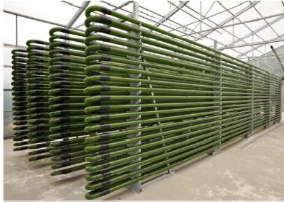
Fig. 35 Fotobiorreactor tubular para la captura de CO 2 . Tomado de [242]
