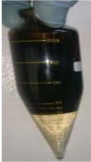
Figura 31. Muestra de Apariencia Liquida con Ausencia de Depósitos Sólidos Durante el Análisis de Centrifugado Muestra proporcionada por la Compañía Operadora Fuente: Compañía Contratista
