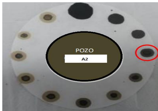
Figura 28. Resultados de la Prueba de Oliensis para la Caracterización de Asfáltenos del pozo
