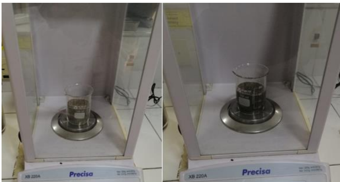
Figura 5. Balanza analítica con las muestras de arena antes y después de saturar de agua
