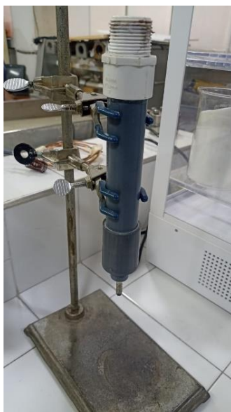
Figura 6. Montaje para medición de la permeabilidad de la arena.
