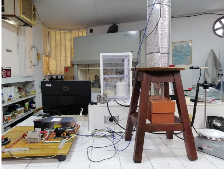
Figura 12. Montaje para las pruebas de recobro con el inductor electromagnético y nanofluidos.
