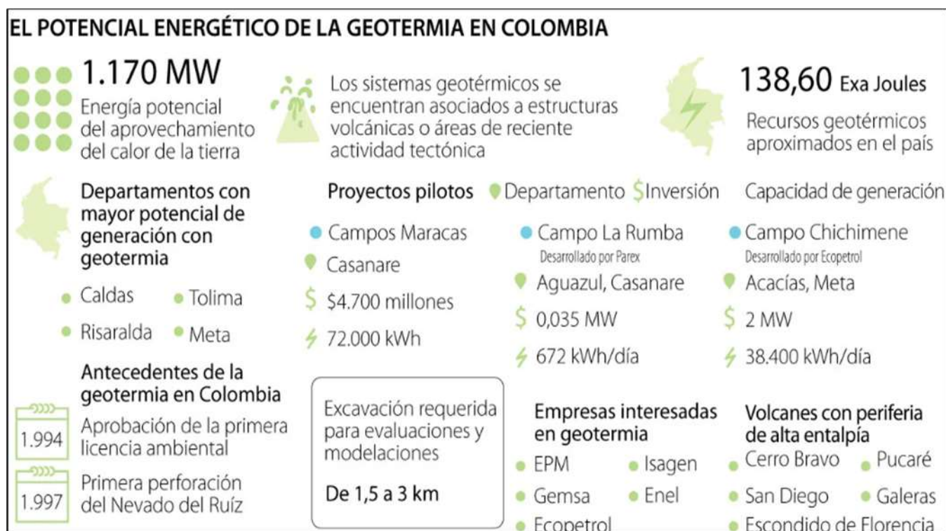
Figura 18. Colombia tiene capacidad potencial de 1.170 MW de generación a través de geotermia
