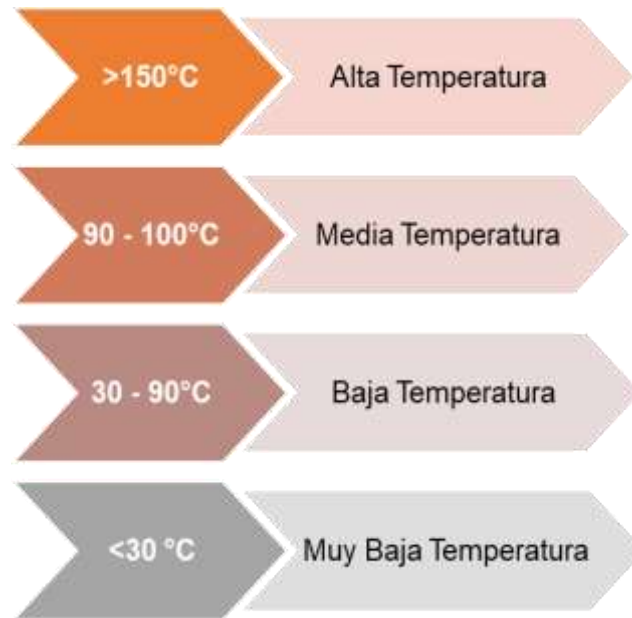
Figura 4 . Clasificación de los yacimientos geotérmicos, según su temperatura.
