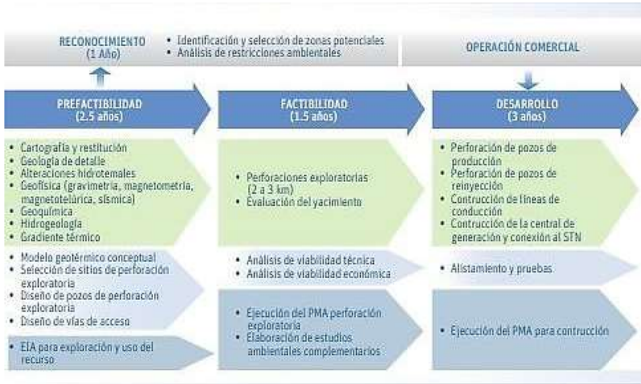
Figura 5. Fases del desarrollo de un proyecto Geotérmico.
