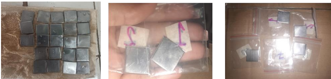
Figura 26. Láminas de acero inoxidable 304 y aluminio. Fuente: Fotos tomadas en el laboratorio.
