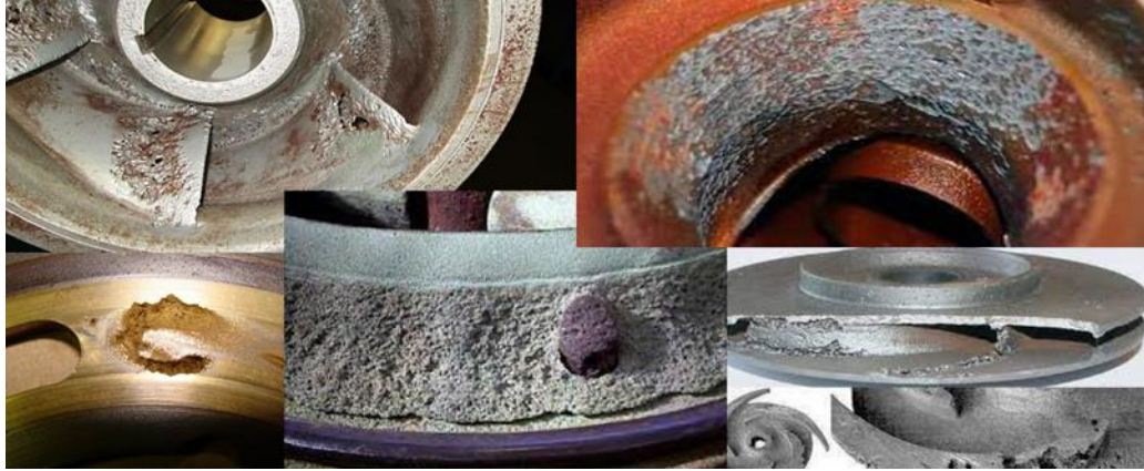
Figura 9. Tipología de corrosión por cavitación Fuente: Tomado de Instituto Asteco, 2021.
