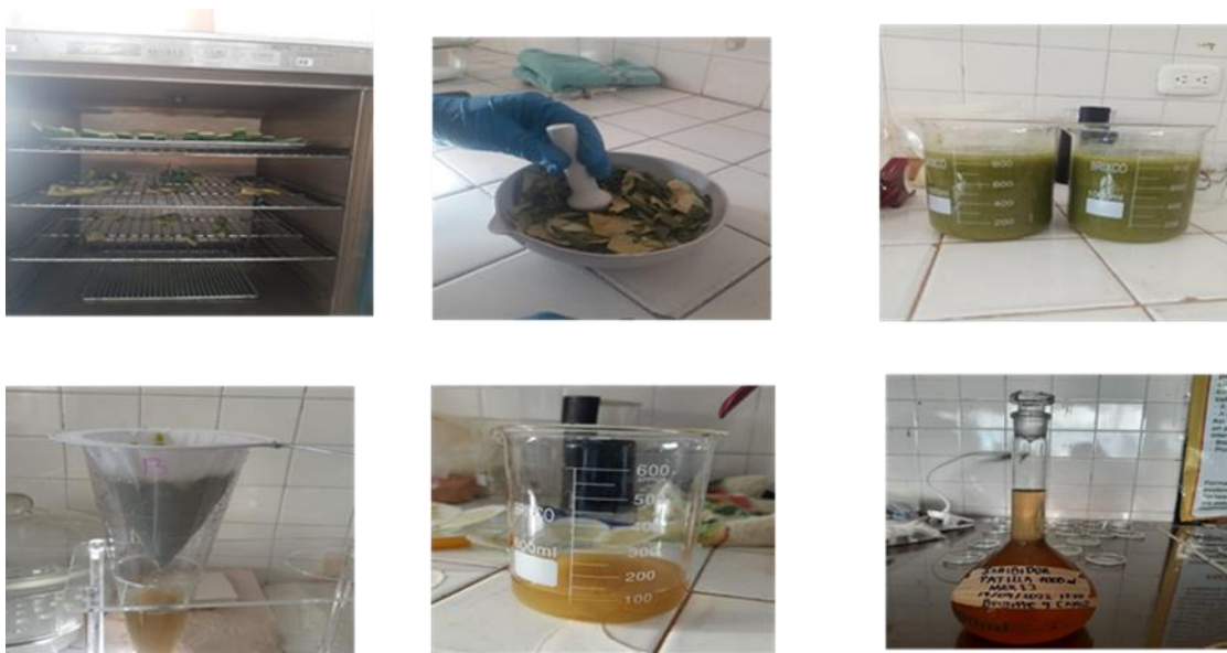
Figura 24. Preparación del extracto. Fuente: Fotos tomadas en el laboratorio.
