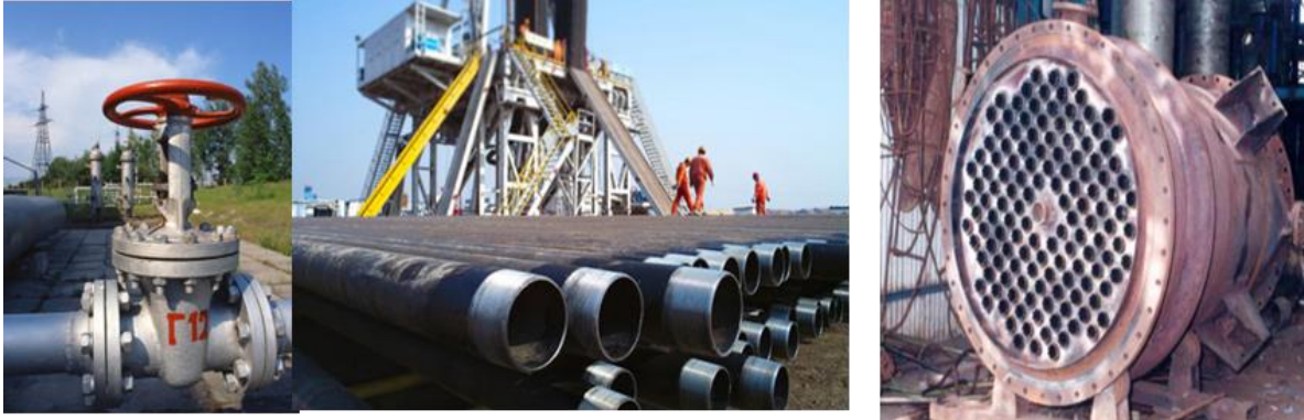
Figura 17. Válvula de acero inoxidable, tubería de acero inoxidable e intercambiador de calor.
