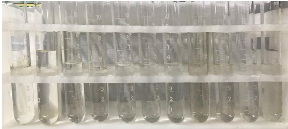
Fotografía 1. Fracciones obtenidas a tasa alta (0.5 mL/min) para 0.1 VP de formulaciones conteniendo la mezcla de surfactantes poliméricos BCPS-6 y BCPS-2 a 0,9% de concentración luego de un waterflooding parcial.
