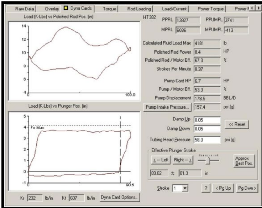
Figura 10. Análisis dinamométrico Fuente: Ing. Gustavo Adolfo Baquero e Ing. José Manuel Gómez Tovar, Manejo de equipo Well Analyzer ECHOMETER
