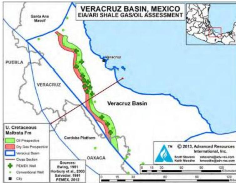
Ilustración 39. Esquema de la Cuenca de Veracruz y Área Prospectiva de Shale Gas y Shale Oil (Advanced Resources International, 2013).
