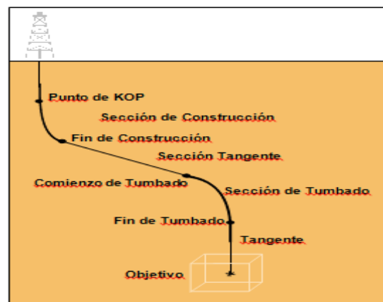
Figura 4.9 Trayectoria de incrementar, mantener y disminuir parcialmente, tipo “S modificada” (build and partial drop and hold).
