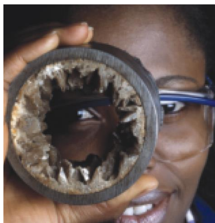
Figura 9 Acumulación de incrustaciones en la tubería de producción. Adaptado de (Mathews et al., 2011).
