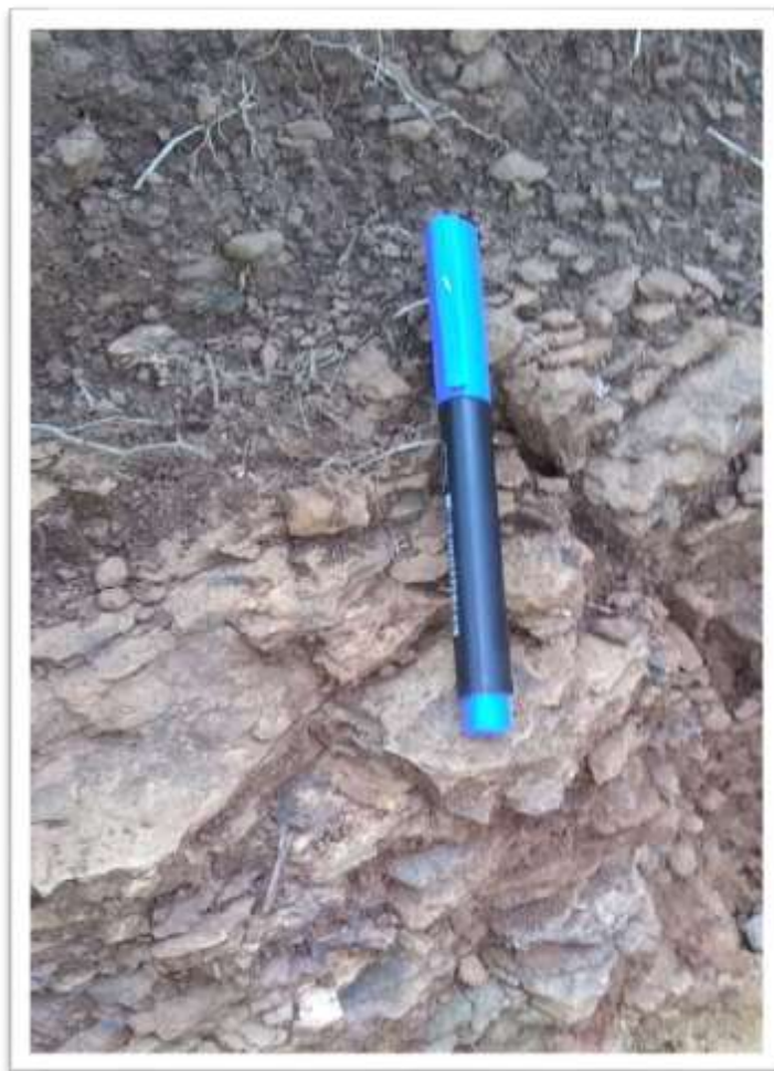
Figura 29: Lodolitas calcáreas de color gris oscuro, fisiles, duras en capas de estratificación fina. Tomada por autores.
